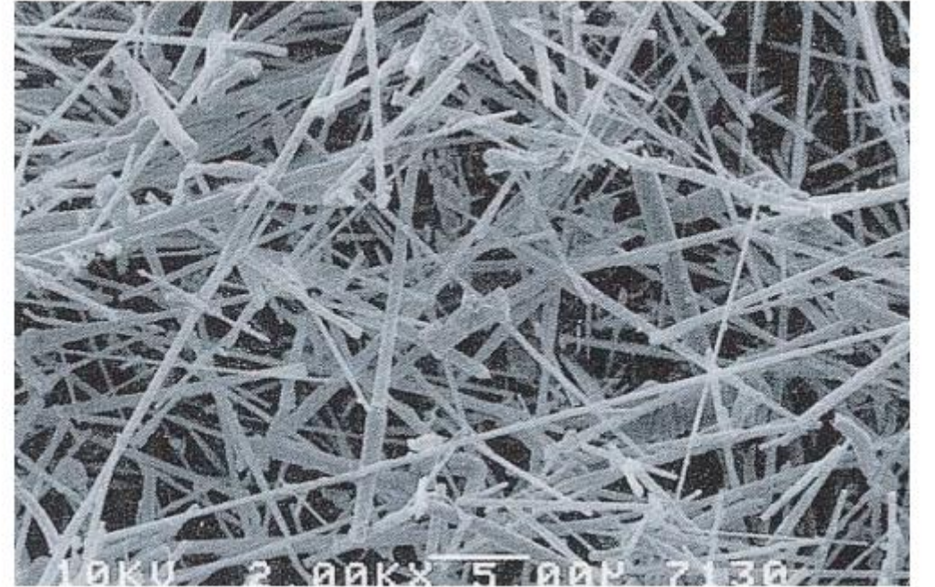
চিত্রঃ সিলিকন-কারবাইড (SiC) হুইস্কার
